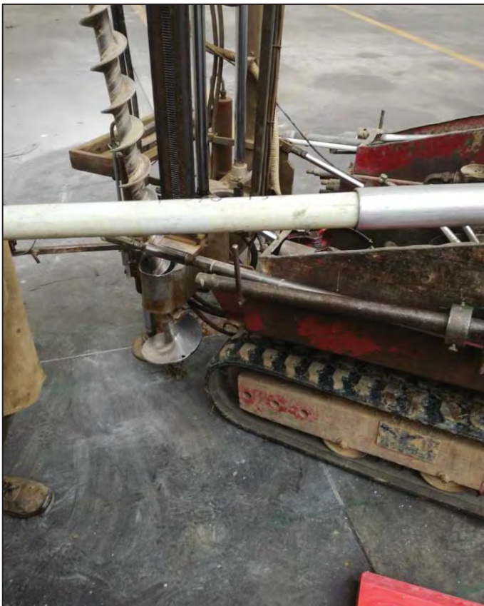
Foto 18 Sondaggio S1, fase di estrazione fustella
