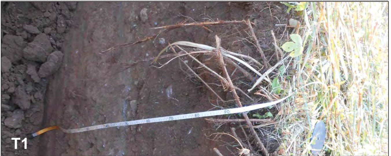
Foto 1 Trincea T1: particolare sezione scavo (profondità dal piano campagna = circa 1,0 m).
